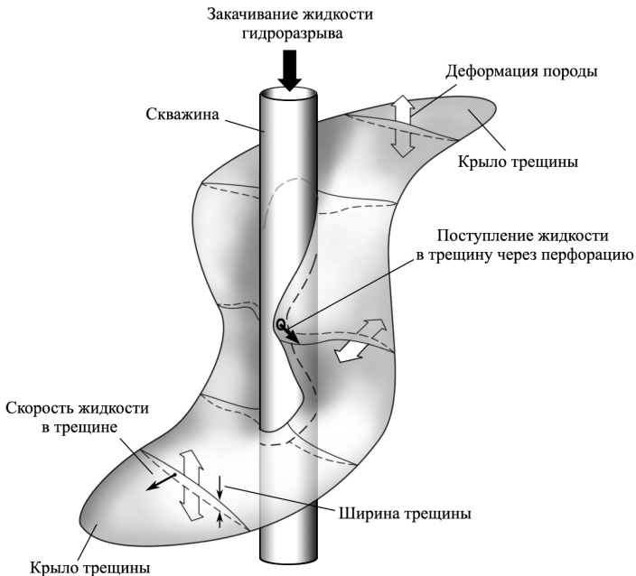
Рис. 1.1. Схематичная картина процесса гидроразрыва пласта.
